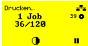
Bild 46: Folienwarnung während eines Druckauftrags: Der Hintergrund ist gelb, das Foliensymbol blinkt.
