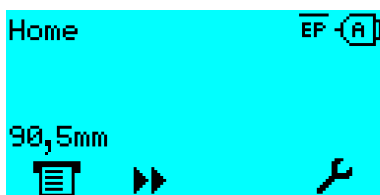
Bild 41: Anzeige des gemessenen Etikettenabstands.
